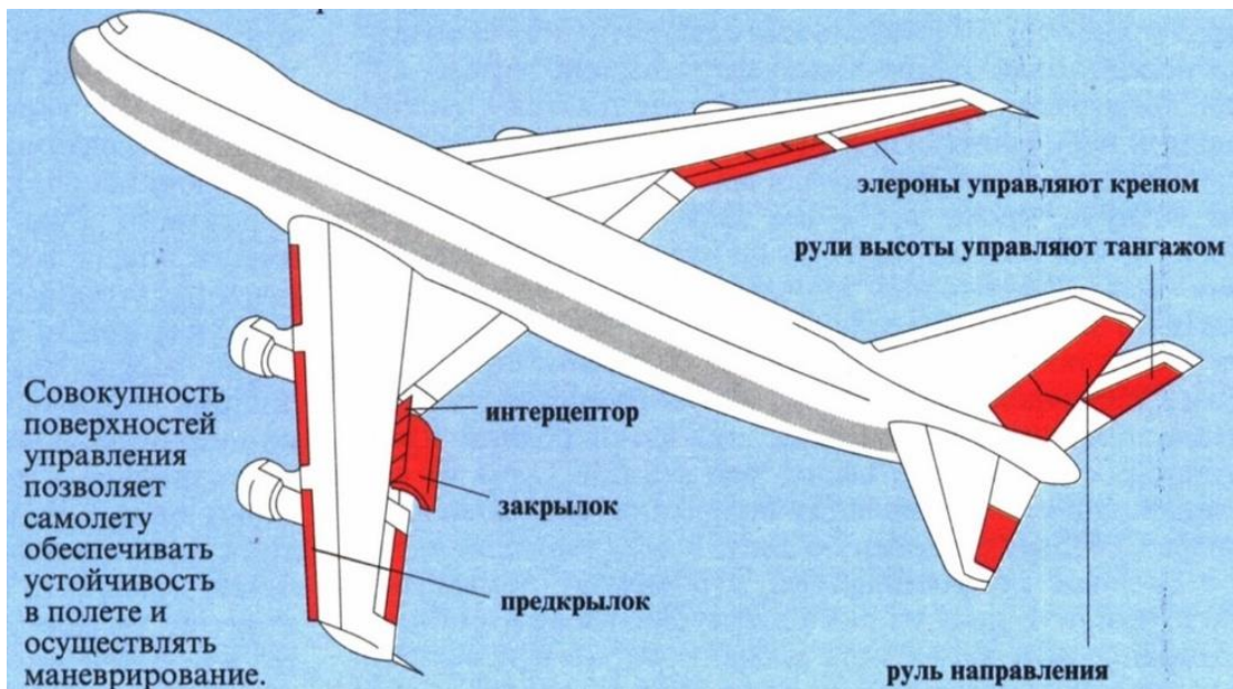
Элементы механизации крыла
