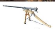
Русская казнозарядная пищаль XVII века с клиновым затвором (калибр — 25 мм; длина — 665 мм)
